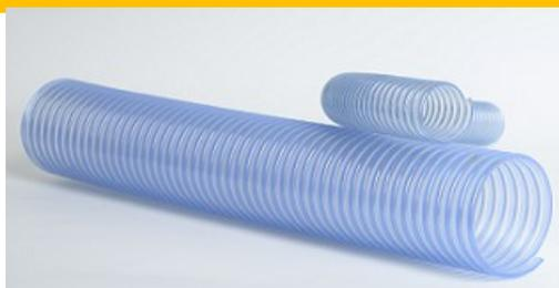
Tuyau en PVC flexible et transparent et renforcé avec spirale en PVC rigide. Intérieur lisse. Extérieur corrugué. Sans dérivés du plomb.
